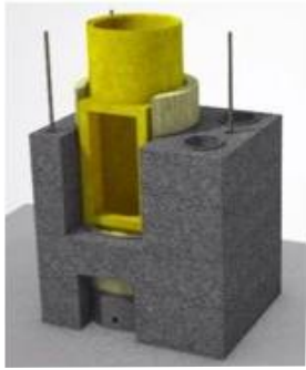
Osazení dvířkové tvarovky
